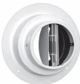
Der Aufbau-Feuerschutzabschluss Prolap besteht aus einem Gehäuse sowie Klappenblätter aus verzinktem, weiß pulverbeschichtetem Stahlblech. Geprüft in EI90-Schachtwänden ab einer Wanddicke von 40 mm sowie in Decken ab 150 mm Deckendicke. Die Prolap wurde für den nachträglichen Einbau in fertige Luftleitungen entwickelt, als Nachrüstung für Alt- und Neubauten.
