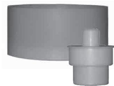
Kondensatablauf mit Geruchsverschluss ohne Sperrwasserhöhe. Wird in kondensatführenden Leitungen, wie bei Lüftungsleitungen, Kamin, Wäschetrockneranlagen, Fancoil-Anlagen etc., anstelle eines herkömmlichen Sifons mit Sperrwasser eingesetzt. Im Inneren des Gehäuses befindet sich eine selbstreinigende Membrane, die gegen die Strömungsrichtung geruchsdicht ist und das anfallende Kondensat
