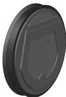
Kaltrauchsperrre LRK/MH hochtemperaturbeständig. Ist rauch- und luftdicht gegen die Strömungsrichtung. Kaltrauchsperrre LRK-MH für den Einbau bzw. Nachrüstung in Luftleitungen. Runde Ausführung, bestehend aus einem Kunststoffgehäuse mit U-Lippendichtung und einem Verschlusselement mit Silikon-Membran, welche durch ein verstellbares Haltemagnet die Kaltrauchsperrre bis zu einem Differenzdruck von ca. 10 Pa in Strömungsrichtung geschlossen hält. Sie wird entsprechend der Luftrichtung in die
