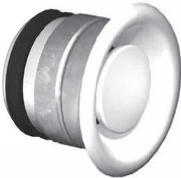
Brandschutz-Tellerventile FLI-VE(ho+ve)90 für Lüftungsleitungen auf Basis intumeszierender Materialien mit mechanischem Verschlusselement, welches zwischen 70 °C und 75 °C auslöst. Der eingelegte Dämmschichtbildner reagiert ab ca. 150
