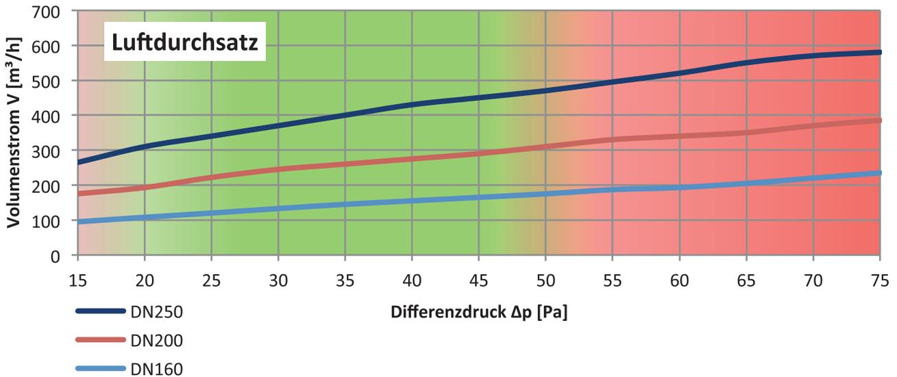
Der Luftdurchsatz wurde in einem geschlossenem System, ohne zusätzlicher Leckagen, wie etwa Türfugen, gemessen.
