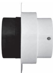
Der Aufbau-Feuerschutzabschluss Prolap-Plus besteht aus einem Gehäuse sowie Klappenblätter aus verzinktem, weiß pulverbeschichtetem Stahlblech und einem luftdichten Rohranschlussstutzen. Geprüft in EI90-Schachtwänden ab einer Wanddicke von 40 mm sowie in Decken ab 150 mm Deckendicke. Die Prolap-Plus wurde für den nachträglichen Einbau in fertige Luftleitungen entwickelt, als Nachrüstung für Alt- und Neubauten.
