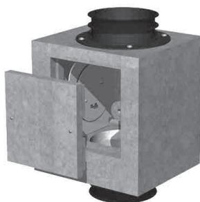
Das querschnittsfreie Deckenschott Prodec-O besteht aus einer imprägnierten Gipsfaserplatte sowie einem mehrschichtigen Klappenblatt aus Edelstahl. Geprüft in Massivdecken ab 150 mm Deckendicke, EI90-Weichschottsystemen ab 100 mm Dicke, 152,5 mm dicken Brettsper Holzdecken und ab 200 mm EPS-Leichtbetondecken. Durch die seitliche Anordnung im Gehäuse verfügt das Deckenschott über einen freien Querschnitt und beeinträchtigt nicht den Luftstrom.
