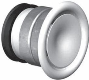
Brandschutz-Tellerventile FLI-VE(ho+ve)90 für Lüftungsleitungen auf Basis intumeszierender Materialien mit mechanischem Verschlusselement, welches zwischen 70 °C und 75 °C auslöst. Der eingelegte Dämmschichtbildner reagiert ab ca. 150
