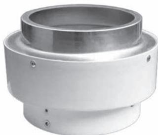
Das Deckenschott Prodec-R besteht aus einem Gehäuse sowie Klappenblätter aus verzinktem, weiß pulverbeschichtetem Stahlblech. Geprüft in Massivdecken ab 150 mm Deckendicke, EI90-Weichschottsystemen ab 100 mm Dicke.
