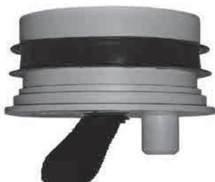
Geruchsverschluss DN 100 mit Entwässerungsstutzen und eingebautem Membransifon. Geruchsverschluss für Lüftungsrohre, Kamine, Heizthermen, Wäschetrocknerleitungen und Ähnliches, bestehend aus einem nichtbrennbaren Kunststoffgehäuse mit U-Lippendichtung, Griff und Kondensatstutzen. Durchmesser 20 mm. Mittels Adapterreduktion
