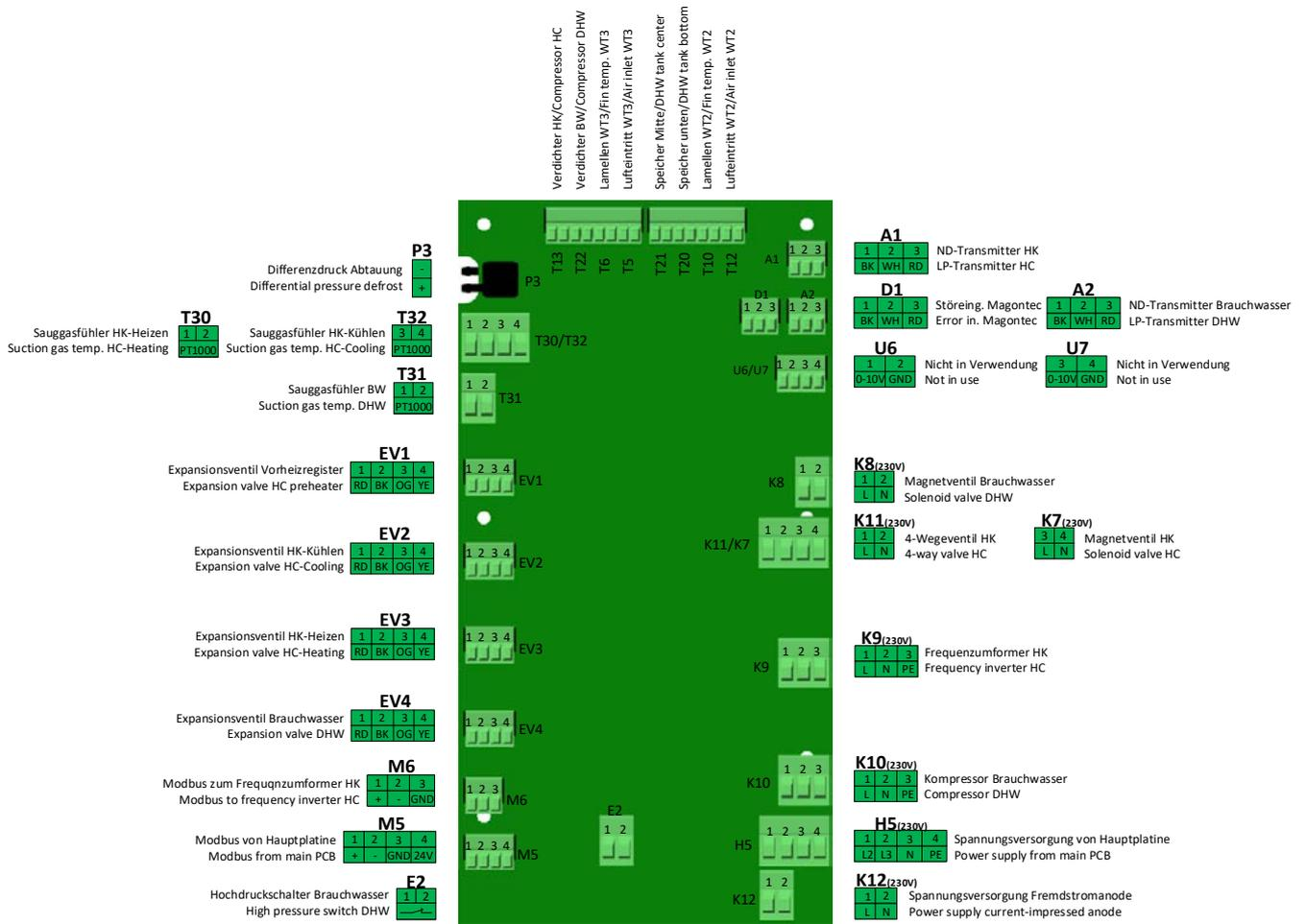
Abbildung: Wärmepumpenplatine linke/rechte Ausführung
