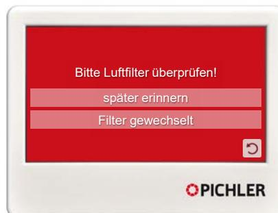
Setzen Sie die Filtermeldung an der Bedieneinheit nach jedem Filterwechsel zurück!
