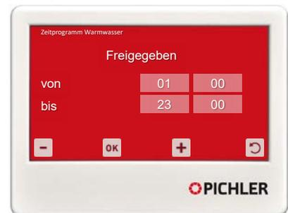
Während des ausgewählten Zeitraumes ist die Wassererwärmung durch die Wärmepumpe und die E-Heizung frei gegeben.
