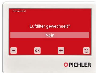
Werden die Luftfilter außerhalb des vorgegebenen Filterwechselintervalls – ohne Filtermeldung – gewechselt, so muss der Filtertimer unter [Menü] > [Aktionen] zurückgesetzt werden. Dieser Vorgang wird automatisch im Filterprotokoll dokumentiert.
