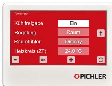
Je nach Einstellung wird nach der Raumluft- oder der Ablufttemperatur geregelt, wobei die gewünschte Temperatur über die Bedieneinheit eingegeben werden kann.
