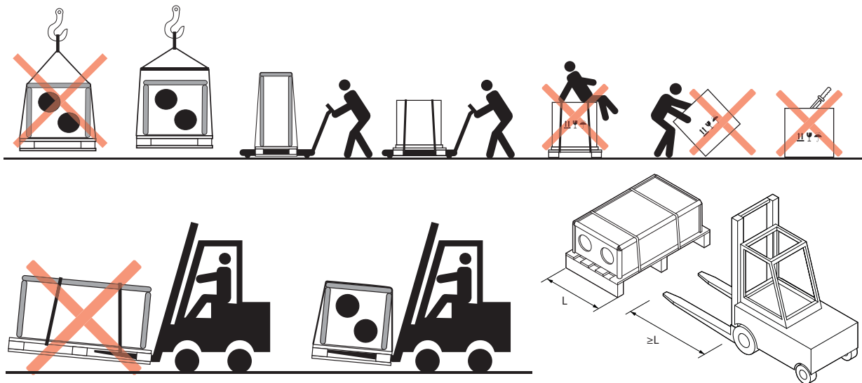
Abb. 4. Beispiele für den Transport mit Kran, Gabelstapler und Trolley
