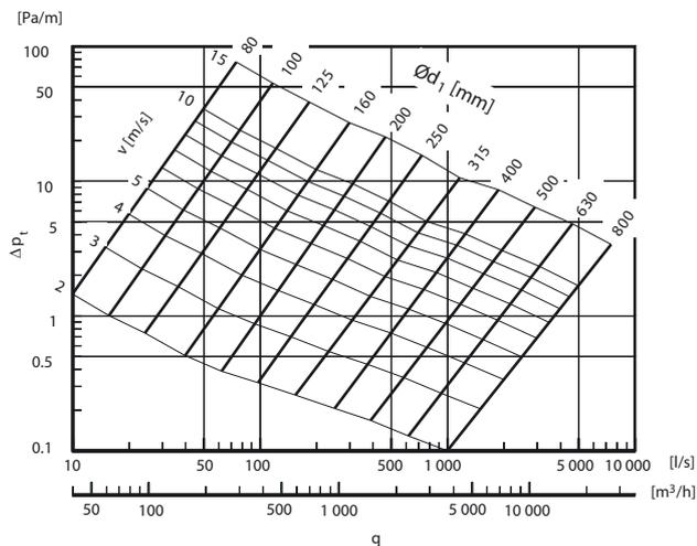
DRUCKVERLUST SLU 3010MK
