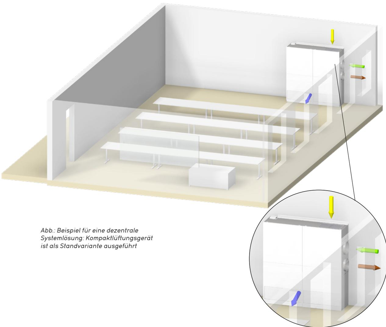
Abb.: Beispiel für eine dezentrale Systemlösung: Kompaktlüftungsgerät ist als Standvariante ausgeführt
