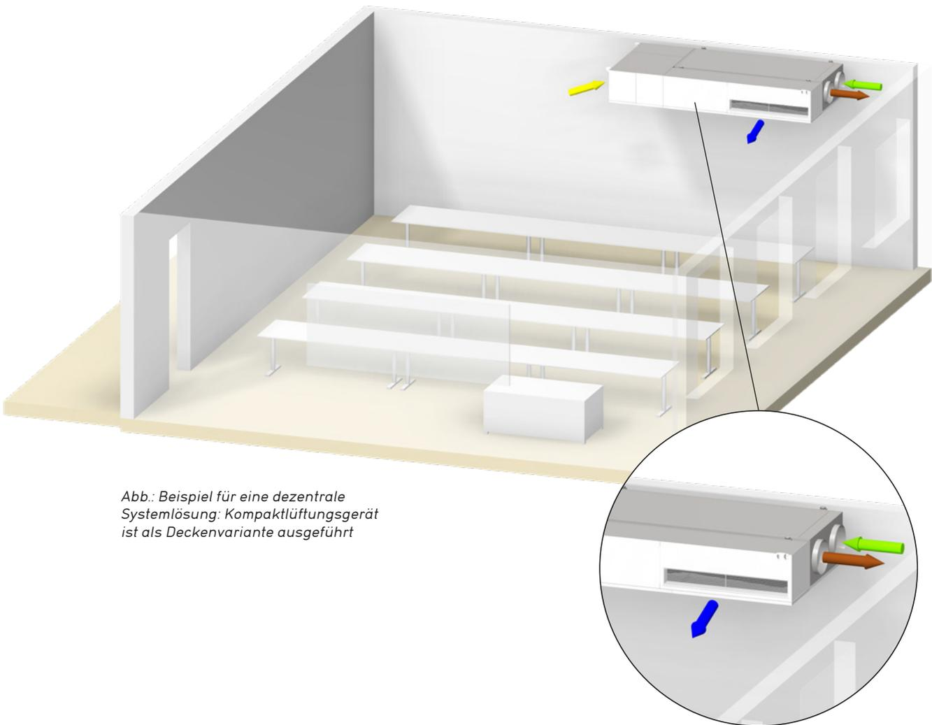
Abb.: Beispiel für eine dezentrale Systemlösung: Kompaktlüftungsgerät ist als Deckenvariante ausgeführt
