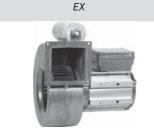
Radialventilator mit Gehäuse aus Silumin. Ex e erhöhte Sicherheit. Kompakte Baugröße. In 230V- und 400V-Ausführung. Volumenstrom bis 1.180 m³/h.
