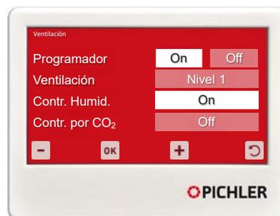
La unidad funciona al nivel de ventilación que se ha establecido en el programa temporizador actual. La programación del programa temporizador se efectúa en [Menú] en [Configuraciones].
