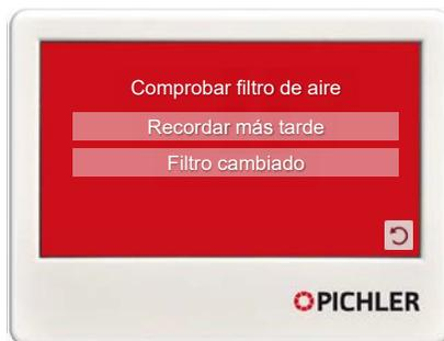
Restablezca el aviso del filtro en la unidad de control después de cada cambio de filtro.
