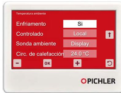
Según sea la configuración, la regulación se realiza según la temperatura ambiente o la temperatura de aire de retorno. La temperatura deseada debe indicarse mediante la unidad de control.
