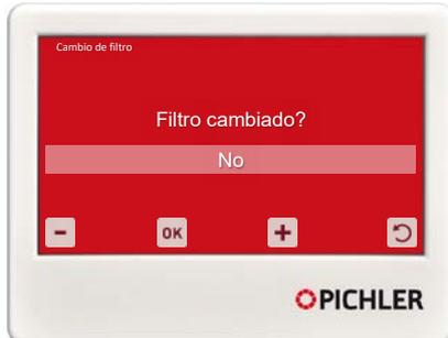
Si se cambian los filtros de aire fuera de los intervalos de cambio predeterminados –sin aviso del filtro– habrá que restablecer el temporizador del filtro en [Menú] > [Acciones]. Ester proceso se documenta automáticamente en el registro de filtros.
