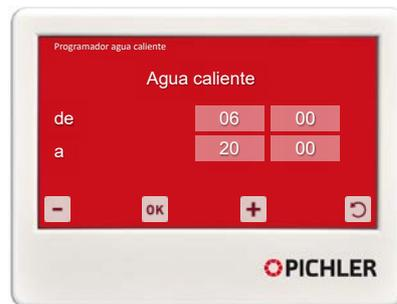
Durante el espacio de tiempo seleccionado, la bomba de calor y la calefacción eléctrica activan el calentamiento del agua.
