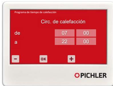
La bomba del circuito de calefacción del módulo opcional del circuito de calefacción está accionada durante el tiempo seleccionado.
