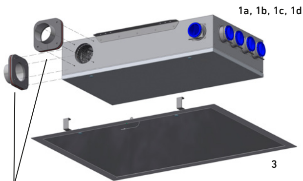
Variable Montage der Anschlüsse seitlich oder hinten. ODA/EHA-Anschluss-Stutzen DN100 mit oder ohne Lippendichtung.
