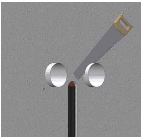
Kunststoffrohre isolieren und bündig mit der Wand kürzen
