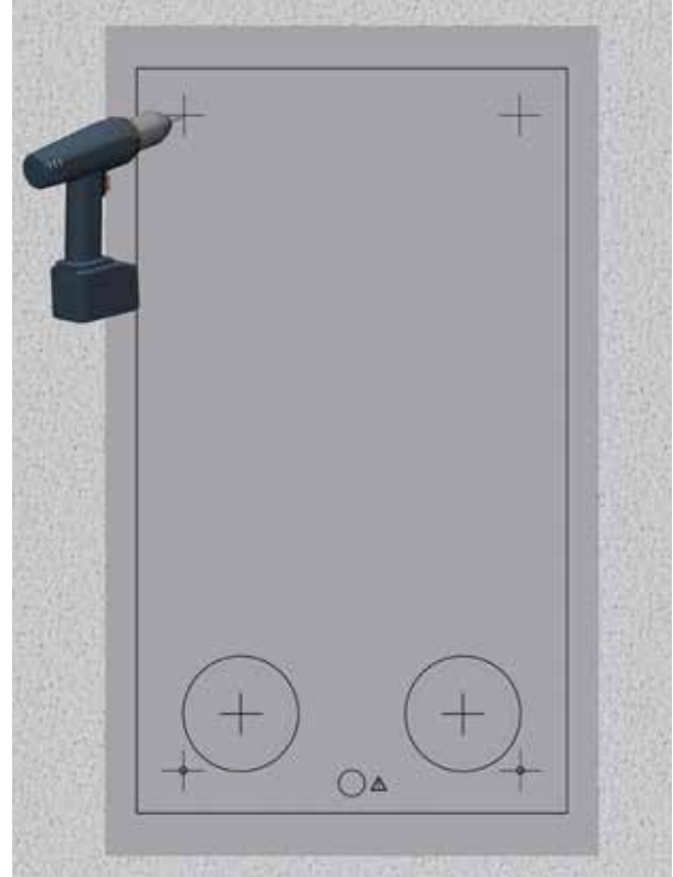
Markierte Löcher bohren
