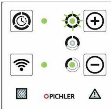
Lüftungsstufe 1 Intensivlüftungsbetrieb für eine definierte Zeit
