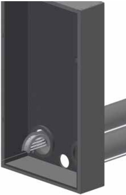
Kunststoffgitter NW170 durch Öffnung führen
