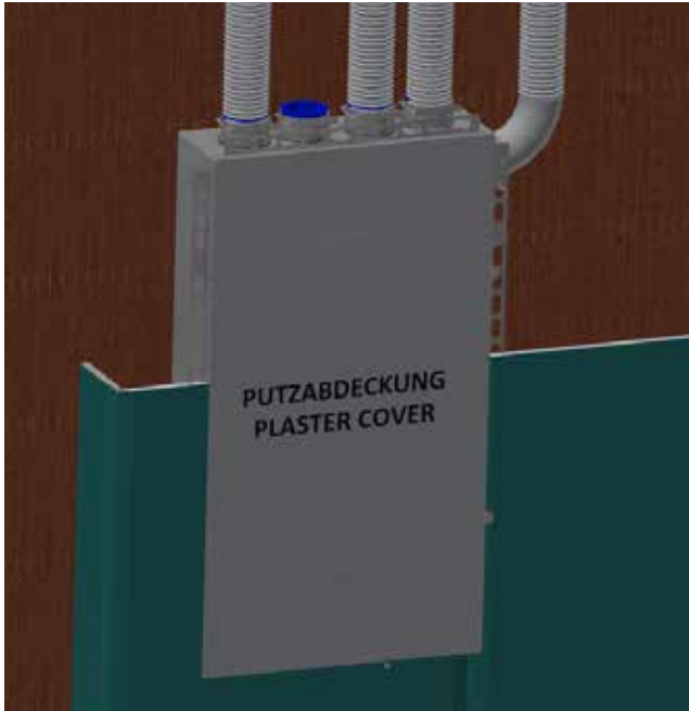
Gipskartonplatten bündig mit Putzkante montieren
