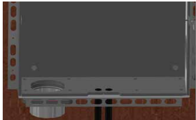
Installationschlauch bündig mit Unterputzgehäuse gekürzt
